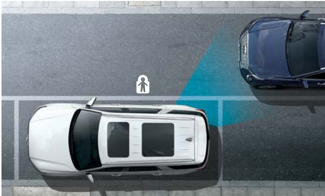
후측방 충돌방지 보조 아웃사이드 미러로 확인할 수 없는 사각지대 또는 후측방에서 접근하는 차량을 감지해 운전자에게 경고합니다. 필요 시 브레이크 제어를 통해 후측방 충돌방지를 보조해 줍니다.
